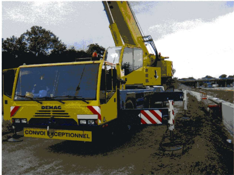
Grúa Demag AC 50.
